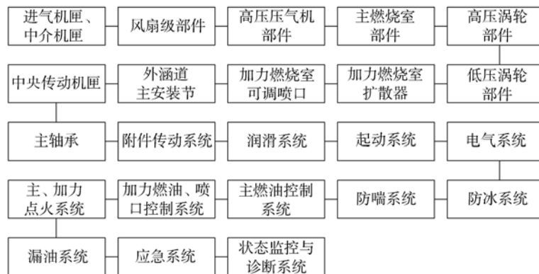
图 5 某型涡扇发动机以部件/附件系统为单元的可靠性模型
